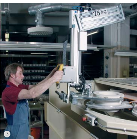
Kipsisen valumuotin nosto ERGOLATOR®illa lavalta ja asettaminen koneeseen.
