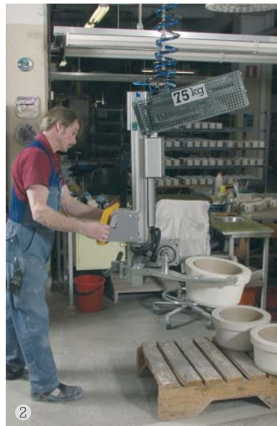
Kipsisen valumuotin nosto ERGOLATOR®illa lavalta ja asettaminen koneeseen.
