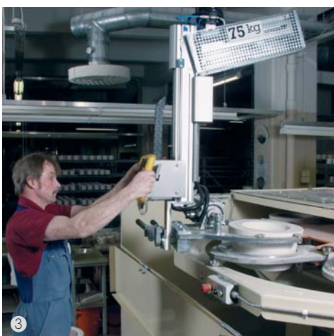
Lyft av gjutkärna med en ERGOLATOR® från pall och upp i maskin.
