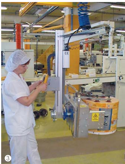
Hantering av stora förpackningsrullar med utvändig gripning då centrumhålet måste hållas fritt.
