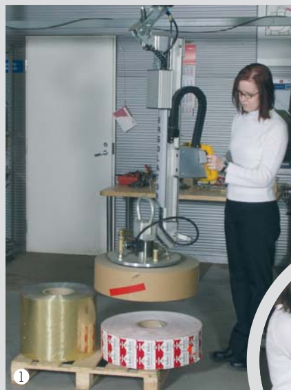
Lyft av rullar med en stor sugkopp från eller till en pall i vertikal eller horisontellt läge.
