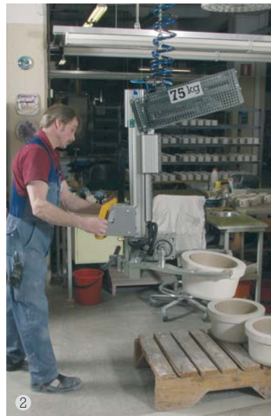
Lyft av gjutkärna med en ERGOLATOR® från pall och upp i maskin.
