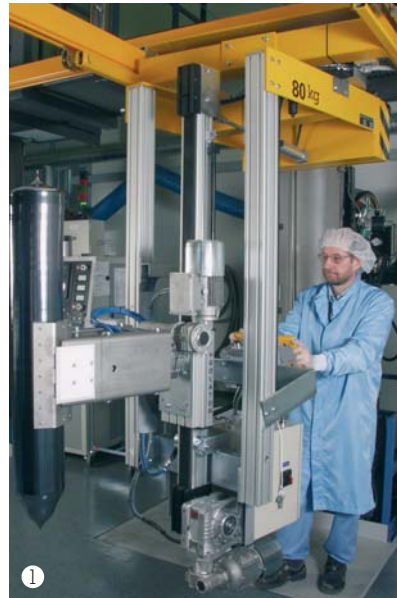
Speciallösning: Hantering av kisellkristall ingjutningsgods med en ERGOLATOR® från en ugn, vridning och placering på transportvagn.
