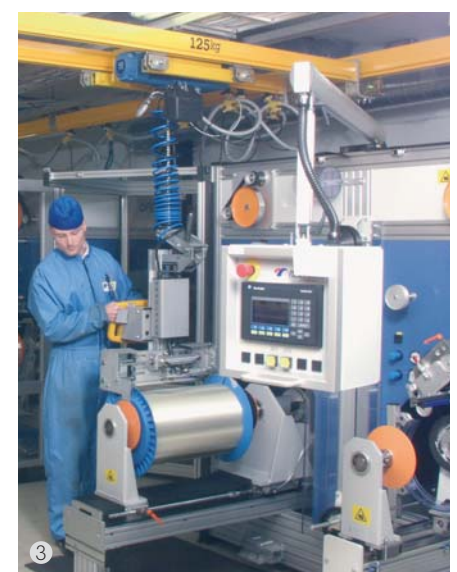
Hantering av kabeltrumma från transportör till upprullningsmaskin med en ERGOLATOR®.
