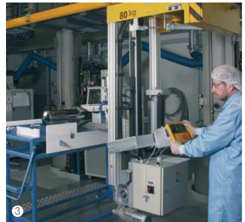
Speciallösning: Hantering av kisellkristall ingjutningsgods med en ERGOLATOR® från en ugn, vridning och placering på transportvagn.
