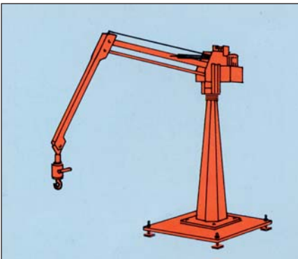
Asennus raskaalle alustalle, jota voidaan siirtää trukilla tai pumppukärryllä.
