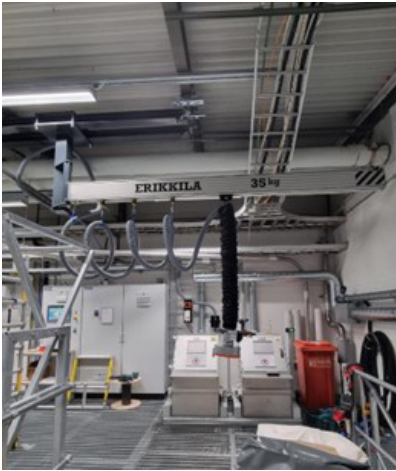
Räätelöity kattoon asennettu alumiinipuominosturi paineilmaletkuasennuksella
