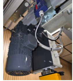
Moottoroitu silta ja sähkötoiminen päätyliikkeen tunnistin
