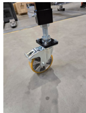
Korkeussuunnassa säädettävä siirrettävän nosturin jalka ja pyörä.
